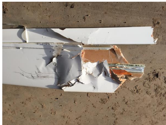
(d) Failure region of W4's outer left wing
